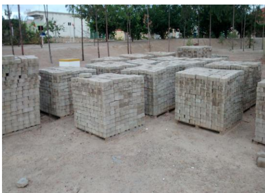
Figura 5- Blocos de concreto produzidos com agregado reciclado de RCD's Fonte: Dados da Pesquisa (2014).
