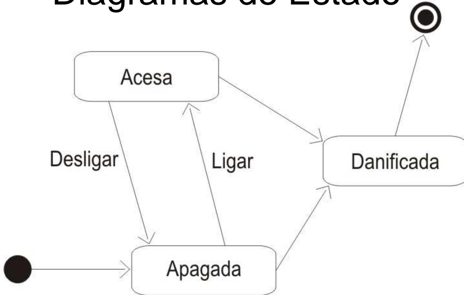
Uma lâmpada: que evolui entre os estados “acesa” e “apagada”, conforme se liga e desliga um interruptor
