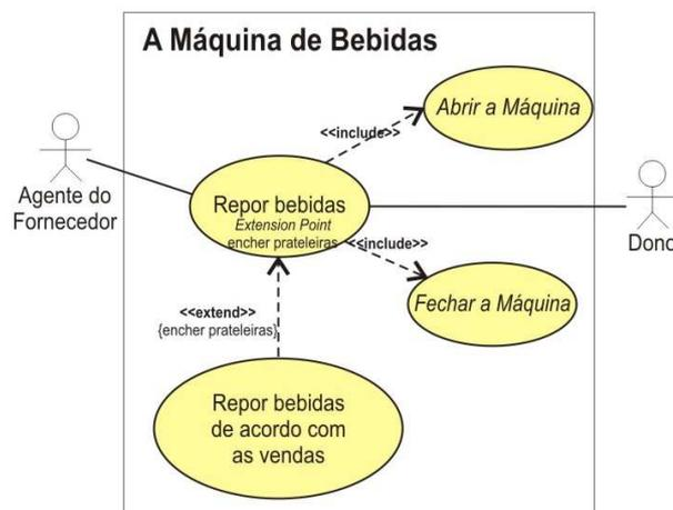
Figura 3. Diagrama de casos de uso da “Máquina de Bebidas” com extensão.
