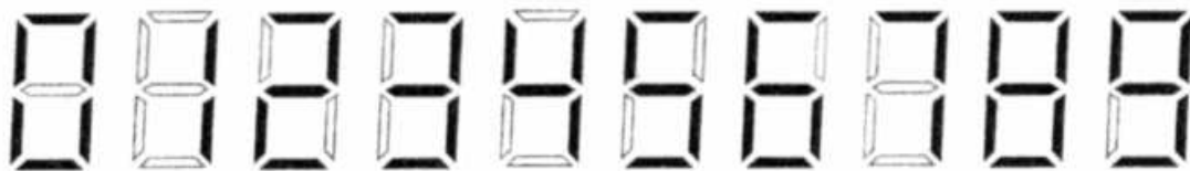
Figura 2: Algarismos decimais possíveis de serem formados mediante o acionamento combinado dos segmentos a, b, c, d, e, f, g .
