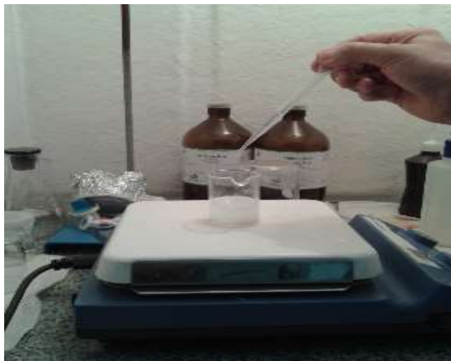
Figura 18: Processo de mistura dos reagentes para à fabricação dos pós de LaOF:Eu: Incorporação gota-gota do fluoreto de amônio.
