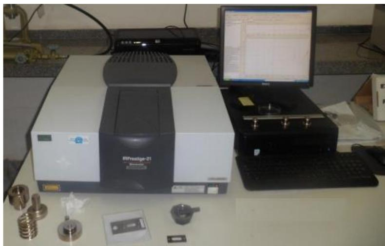
**Figura 12:** Espectrômetro de Infravermelho por Transformada de Fourier.
