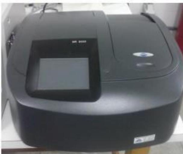
**Figura 13:** Espectrofotômetro UV-Visível
