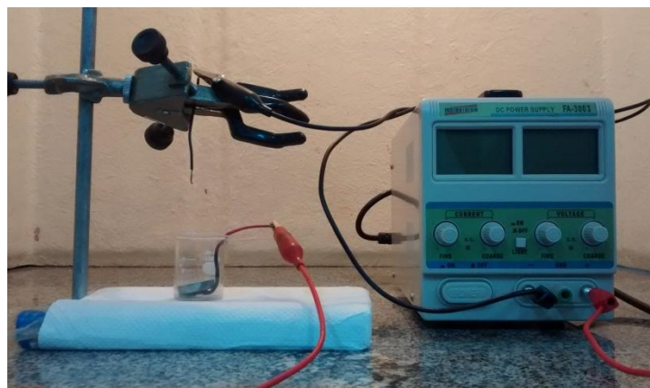
Figura 23 - Montagem experimental para síntese eletroquímica do polipirrol ramificado.
