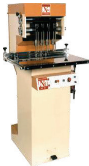
Figura 4 - Furadeira para papel semi-automática equipada com dispositivo de emergência. Ano de Fabricação 1999 (Fonte: Dissete, 2006)
