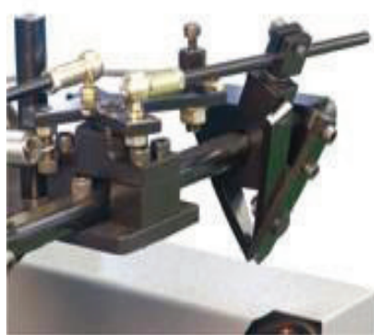
Figura 6 - Mecanismo para cortar e dobrar as pontas das espirais; Fonte: Dissete, 2006
