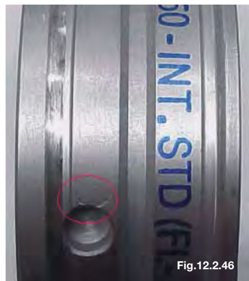
Marca do pino na parte externa da bronzina
