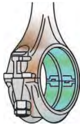
CAPAS INVERTIDAS OU TROCADAS
