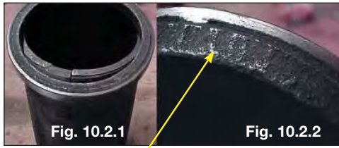
Camisa molhada. Região do colarinho da camisa rompido e carbonizado
