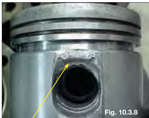
Desgaste do pistão na região do cubo e topo provocado pela trava
