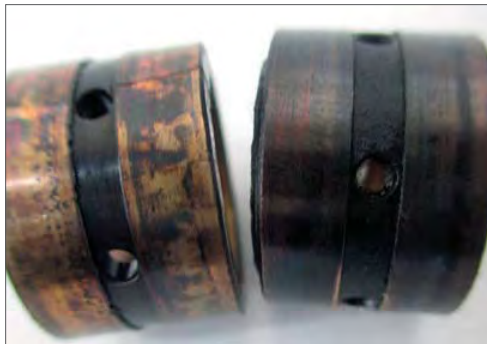
Fig. 22.1.1.1 – Lubrificação deficiente nos mancais radiais.
