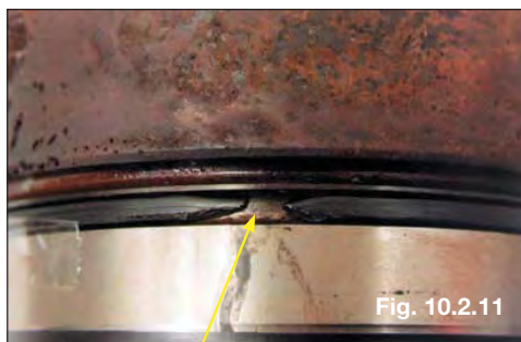
Fig. 10.2.11: Anel o'ring cortado durante a instalação da camisa no bloco
