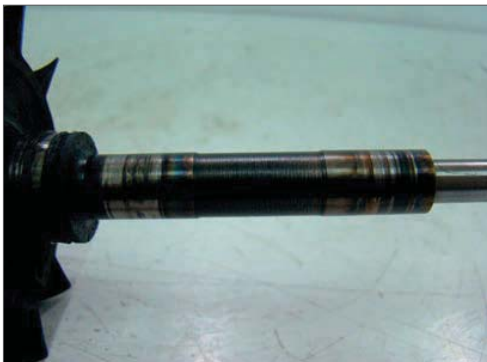
Fig. 22.1.1.2 – Lubrificação deficiente no eixo rotor.
