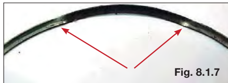
Anel montado torcido
