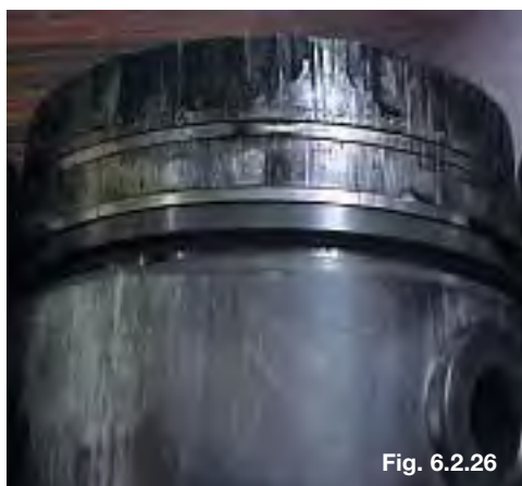
Engripamento iniciado na zona de fogo
