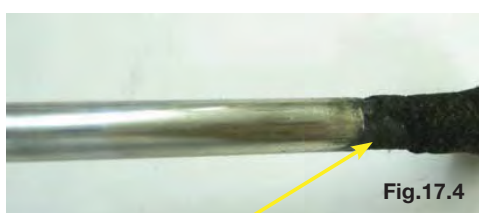
Engripamento em função de resíduos de carvão fixados na haste
