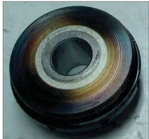
Fig. 22.1.1.4 – Lubrificação deficiente no colar centrífugo.
