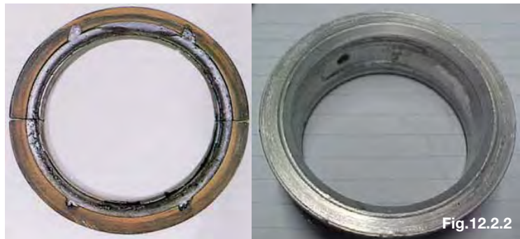
Flange totalmente desgastado
