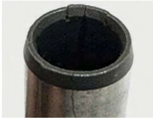
Detalhe da quebra do diâmetro interno
