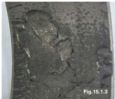
Marca interna provocada pelo corpo estranho
