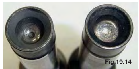
Mosca com apoio irregular da vareta de válvulas
