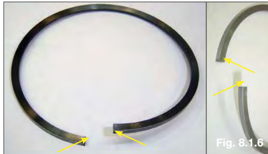
Pontas desalinhadas devido à montagem incorreta
