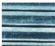
Anel de 1º canaleta. Face de trabalho – faixa de contato com o cilindro. 180° do GAP.
