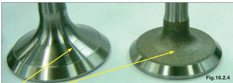
Cabeça retificada e sem ser retificada
