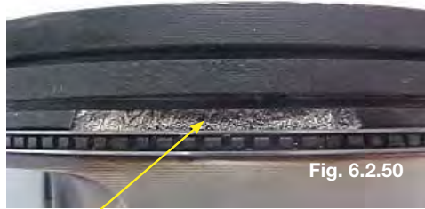
Parede entre canaleta quebrada em pistão aplicado em motores Ciclo Otto
