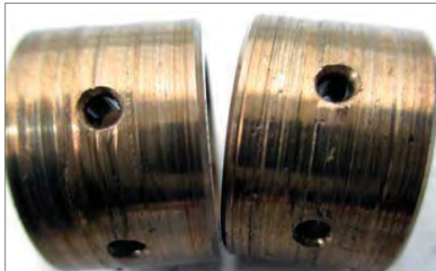
Fig. 22.1.2.1 – Riscos provocados por óleo lubrificante contaminado.
