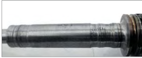
Fig. 22.1.1.5 – Desgaste causado por baixa pressão de óleo lubrificante.
