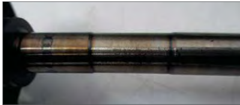
Fig. 22.1.1.6 – Marcas circulares no eixo, indício de parada a quente.
