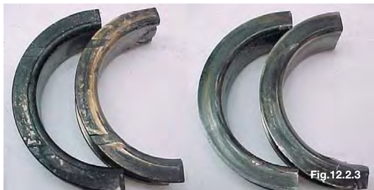
Flange do lado dianteiro da bronzina sem desgaste e do lado traseiro com desgaste
