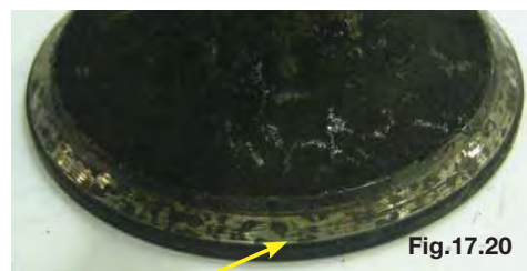
Pontos de contaminação do assento da válvula por resíduo de carbono
