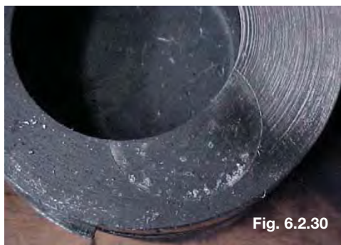
Marca de válvula no topo usinado do pistão
