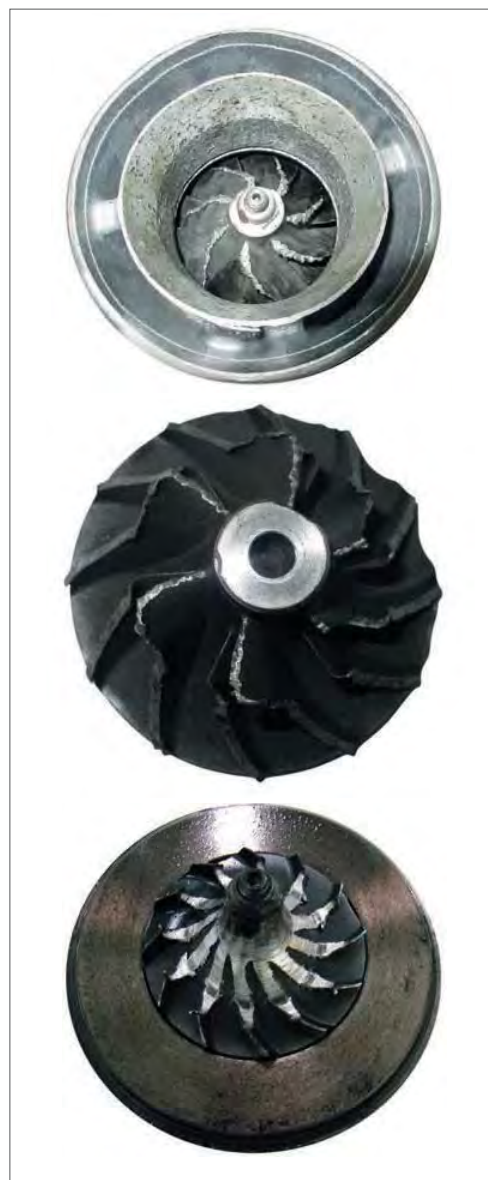
Fig. 22.2.2 (1), Fig. 22.2.2 (2) e Fig. 22.2.2 (3) – Admissão de corpo sólido
