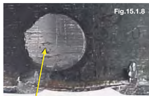
Marca externa provocada pelo corpo estranho
