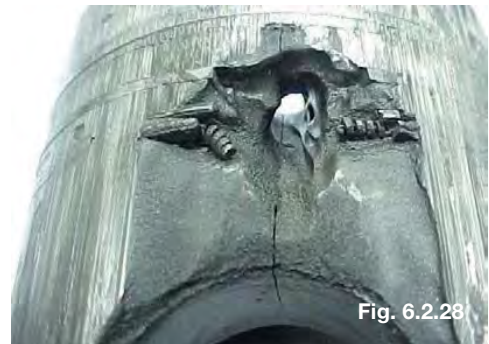
Destrução do topo e da região do cubo devido ao bico injetor com funcionamento irregular
