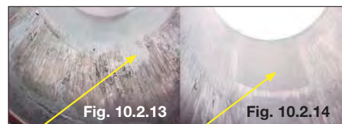
Fig. 10.2.13 and Fig. 10.2.14: Engripamento originado pela diluição do óleo lubrificante existente na parede do cilindro
