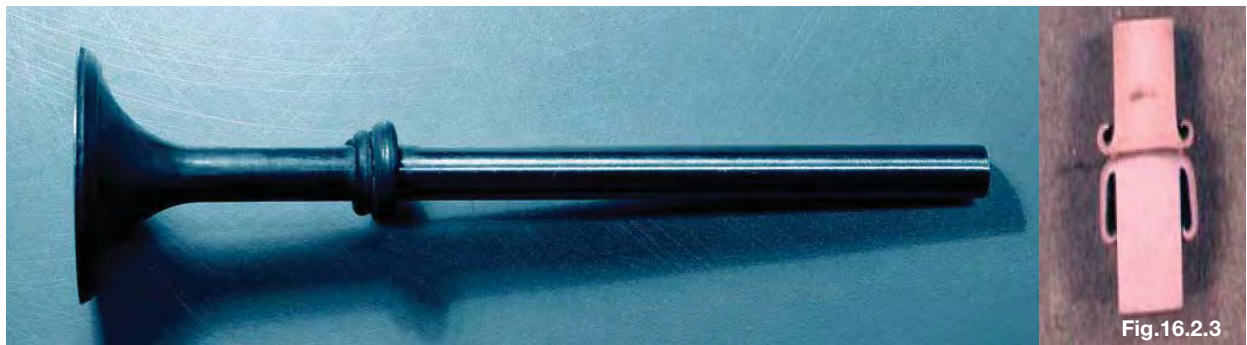
Região da solda na válvula bimetálica
