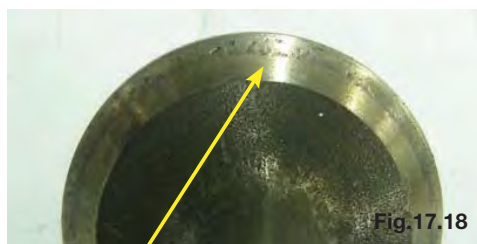
Desgaste na região da cabeça da válvula
