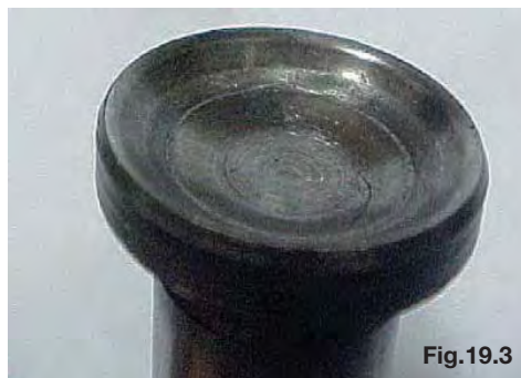
Desgaste excessivo da base
