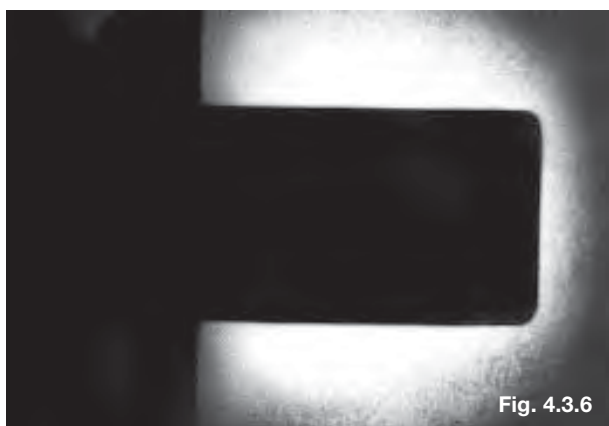
Secção da 2ª canaleta, praticamente sem desgaste.
