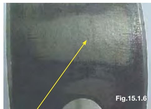
Marca de apoio irregular da bucha com alojamento
