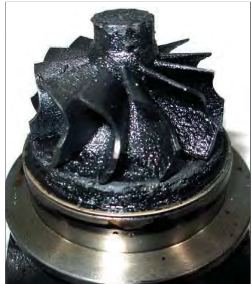
Fig. 22.4.2 – Óleo no rotor da turbina.
