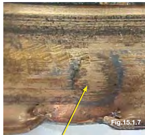
Marca interna provocada pelo corpo estranho
