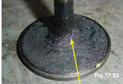
Válvula de admissão contaminada com óleo lubrificante devido à folga excessiva entre a haste e a guia ou a retentor/vedador deficiente
