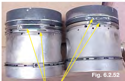
Paredes entre canaletas fraturadas em pistões aplicados em motores Ciclo Diesel
