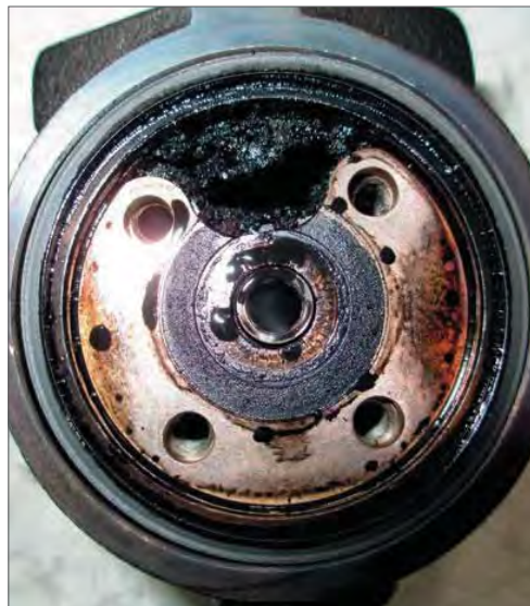
Fig. 22.3.3 – Carbonização do óleo lubrificante decorrente de temperatura elevada.
