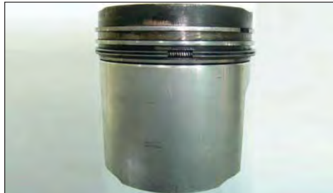
Pistão com características normais de funcionamento
