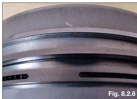
Anel da terceira canaleta desgastado
