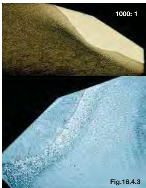
Ampliação do revestimento aplicado na sede da válvula
