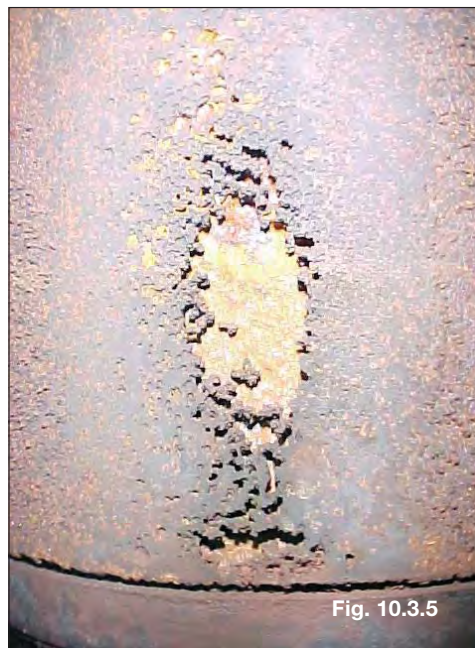
Cavitação sem corrosão
