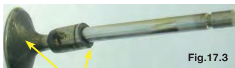
Empenamento devido ao atropelamento da válvula pelo pistão
