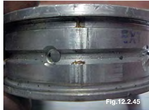
Cola/adesivo no canal de lubrificação externa da bronzina
