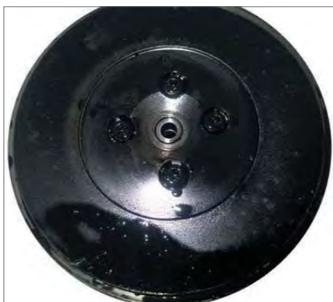
Fig. 22.5.2 – Óleo lubrificante no prato, provocado por restrição de ar.
