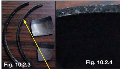
Camisa seca. Região do colarinho da camisa carbonizado
