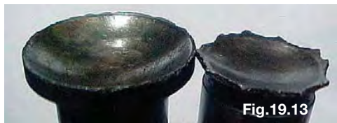
Detalhe de desgaste e quebra da base
