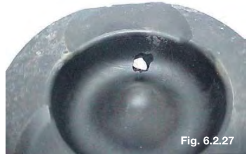
Destrução do topo e da região do cubo devido ao bico injetor irregular
