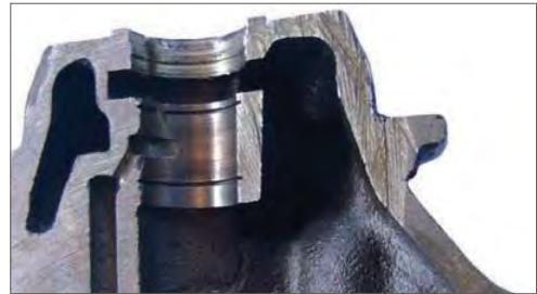
Fig. 22.1.1.3 – Riscos no alojamento da carcaça central.
