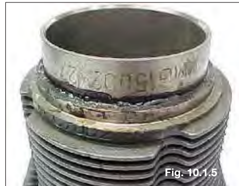
Camisa montada com cola na base inferior
