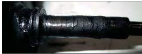
Fig. 22.1.1.7 – Eixo com excesso de carvão.
