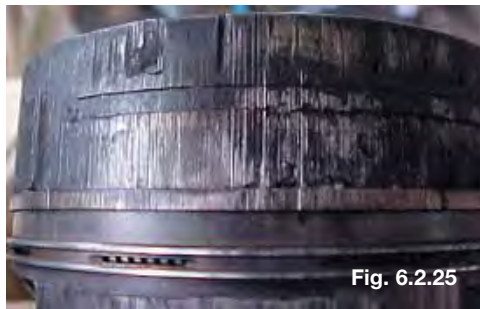
Engripamento iniciado na zona de fogo
