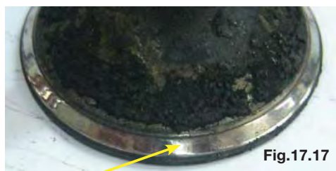
Desgaste na região da cabeça da válvula
