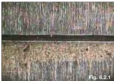
Anéis com riscos na face de contato
