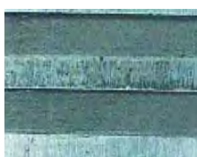
Anel de 2º canaleta. Face de trabalho – faixa de contato com o cilindro. 180° do GAP.
