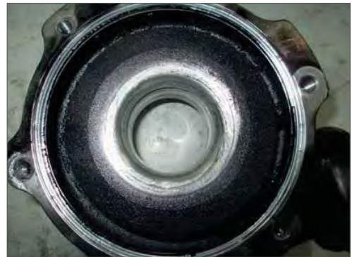
Fig. 22.4.3 – Borra de óleo na carcaça compressora.
