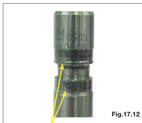
Desgaste na região do canal de trava provocado por irregularidade na trava
