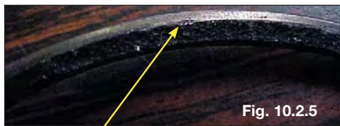
Região do colarinho da camisa carbonizado
