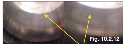
Fig. 10.2.12: Camisa "espelhada" devido à rotação constante
