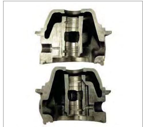
Fig. 22.1.2.3 – Carcaça central com riscos causados por impurezas.
