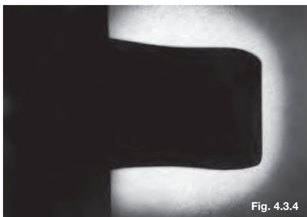
Secção da 1ª canaleta do anel de fogo. Note-se o pequeno desgaste do pistão, após 360.000 quilômetros.
