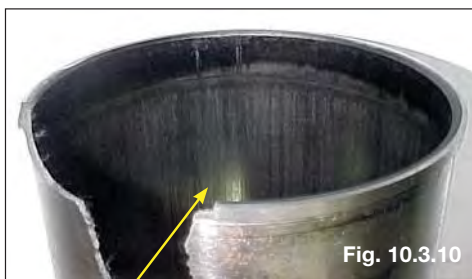
Desgaste e risco provocados por partículas sólidas admitidas para dentro do cilindro
