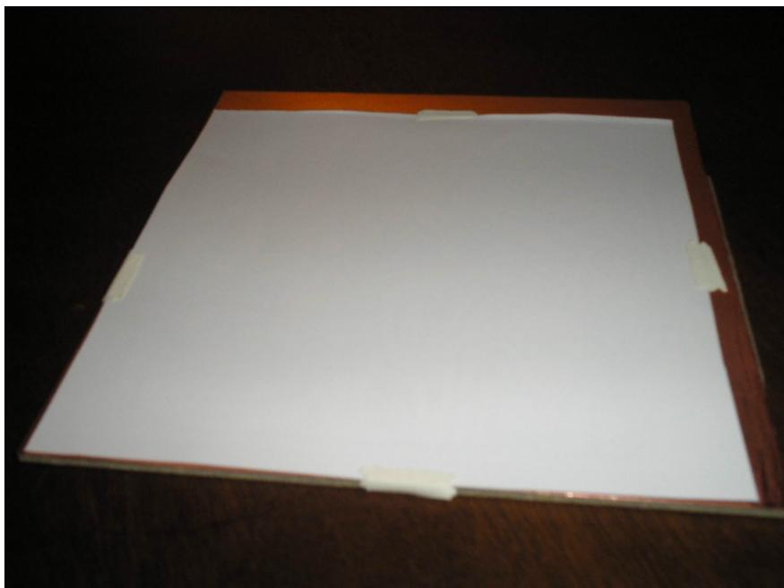
Bueno, agora posicione a face da placa com papel para baixo sobre uma superfície plana de material resistente a altas temperaturas (ainda melhor se a superfície refletir o calor de volta à placa). A foto ilustra uma pedra de granito (o pano só serve para a pedra não arranhar a superfície de baixo):
