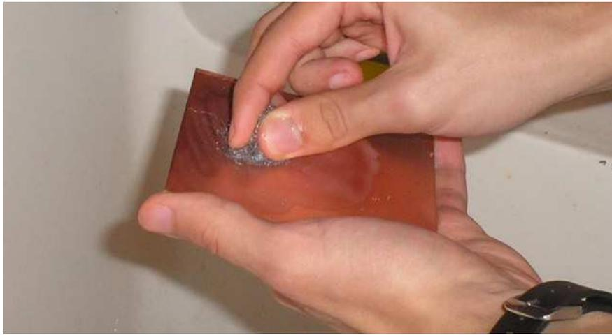
Para tirar o sabão e a sujeira da placa, use água corrente forte (afaste a placa verticalmente da torneira para que a energia potencial gravitacional faça seu trabalho, e economize água e dinheiro!). Tire suas mãos sujas da placa! Agora ponha a superfície cobreada da placa sobre um papel toalha dobrado ao meio (melhora a absorção de água) e pressione cada ponto:
